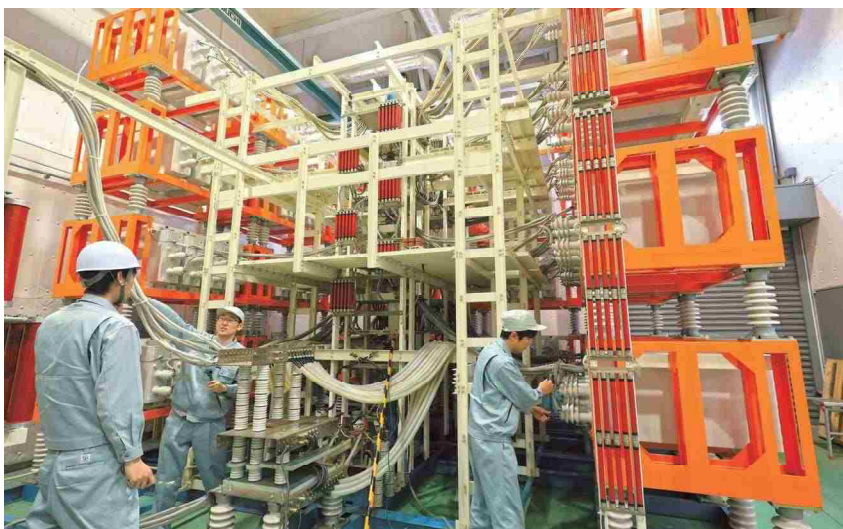
22万アンペアの直撃雷を発生させることができる、世界最大級の雷電流発生装置。
